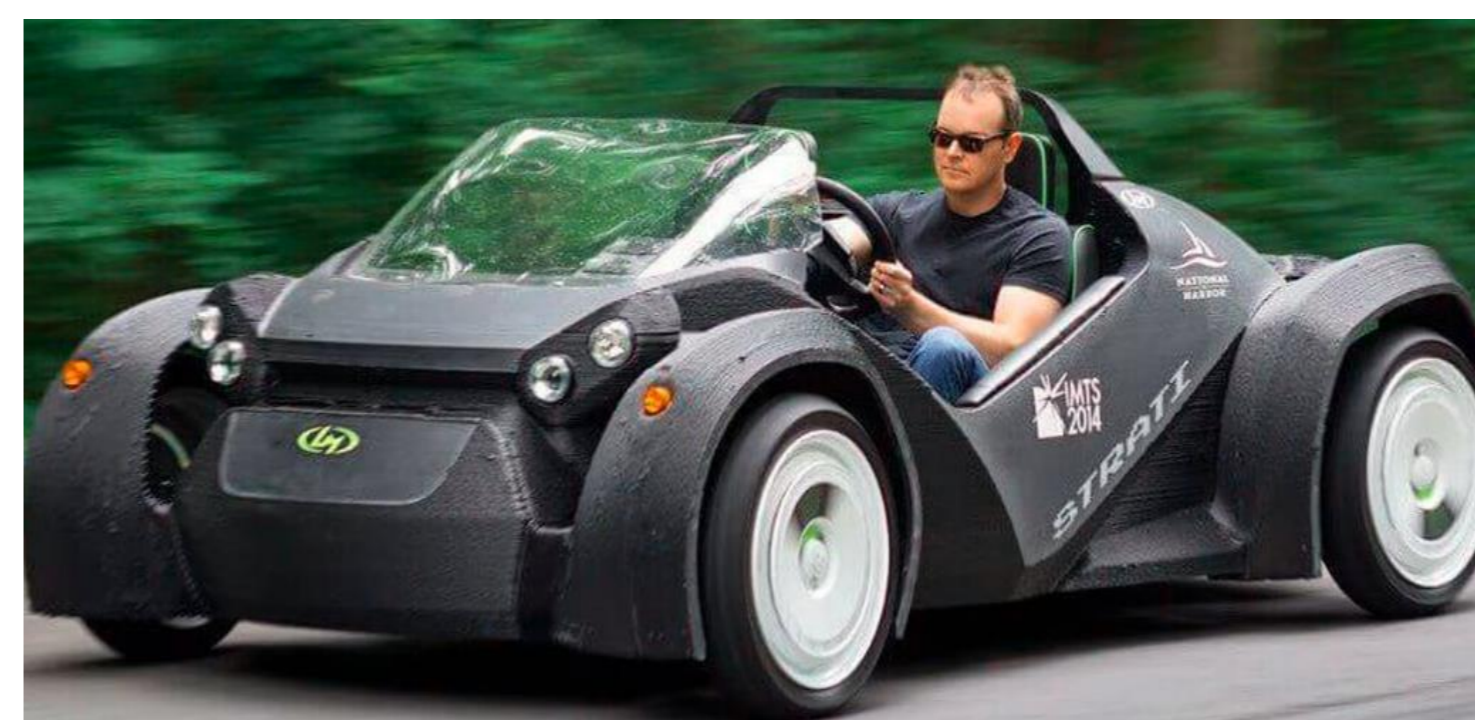
Rys 8,9. Samochód Strati karoseria samochodu została wykonana z druku 3D [10]
