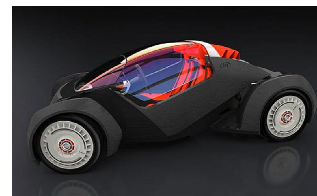
Rys 7. Karoseria Samochodu wykonanego z filamentu ABS wzmocnionym włóknem węglowym[10]
