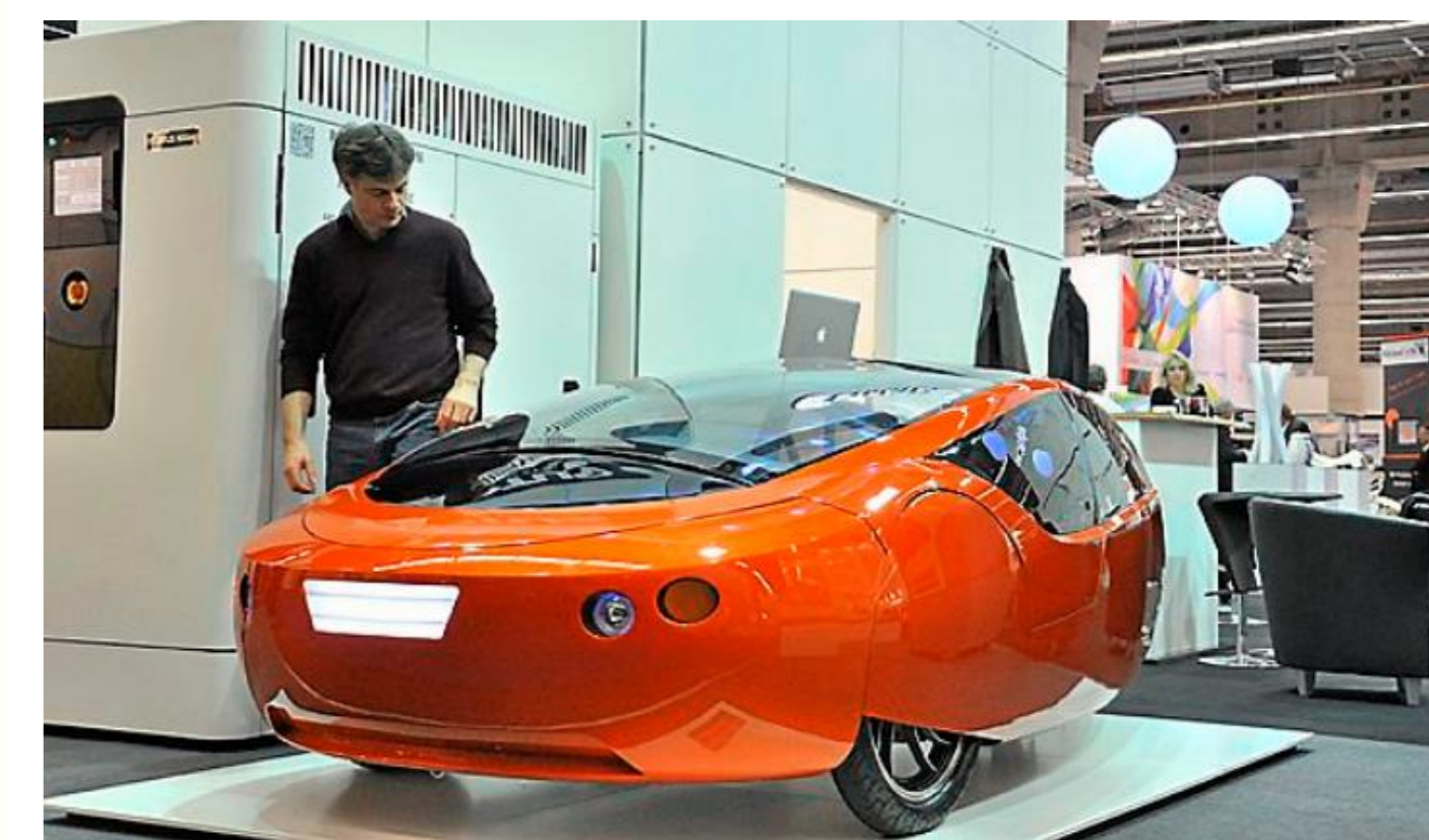
Rys 6. Urbec samochód całkowicie wytworzony metodą druku 3D [9]
