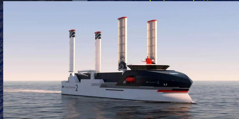
Energy Observer 2 - prototyp statku towarowego zasilanego ciekłym wodorem (Fot: JB Epron Design / Kadeg Boucher )
