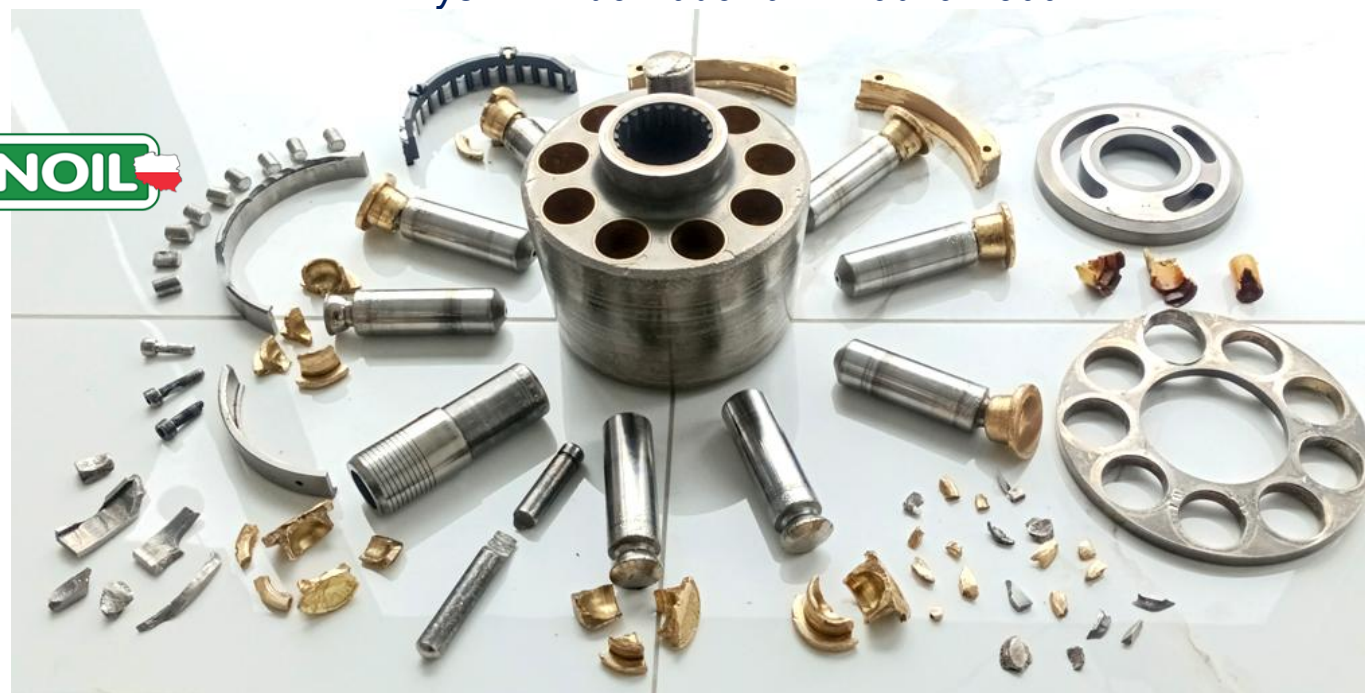
Rys. 3. Widok uszkodzonej pompy wielotłoczkowej ładowarki Liebherr 566
